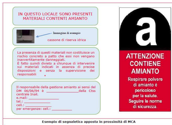
Esempio di segnaletica apposta in prossimità di MCA
