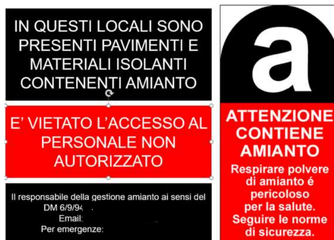
Figure 32 - esempi di cartellonistica utilizzata per segnalare la presenza di MCA, contenente le avvertenze di sicurezza e i riferimenti per eventuali comunicazioni
