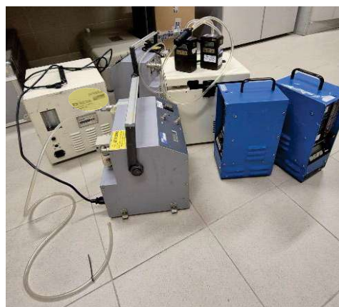
Figura 46 - pompe di campionamento per alti e bassi flussi
