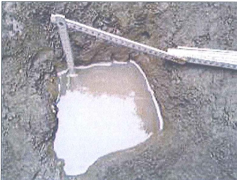
*Particolare della prova di permeabilità eseguita presso il cimitero di Mezzana Casati*
